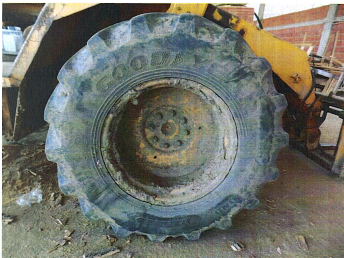
11. Utovarivač JCB - telehandler – istrošenost guma
