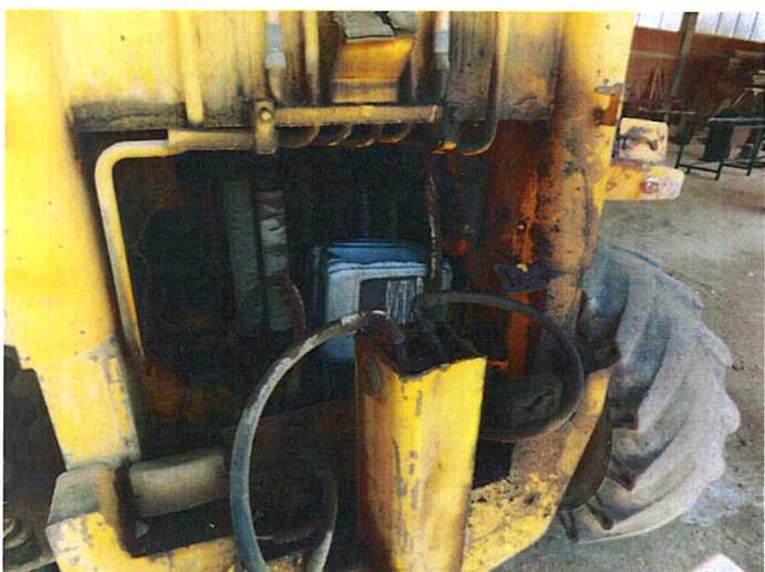
5. Utovarivač JCB - telehandler – oštećenje hidraulike
