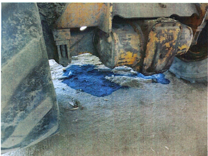
9. Utovarivač JCB - telehandler – ulje iscurilo iz motora
