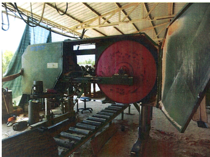
5. Horizontalna pila Terglav – pogled na zamašnjake
