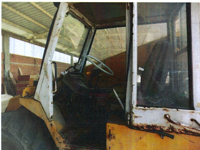
7. Utovarivač JCB - telehandler – oštećenje kabine
